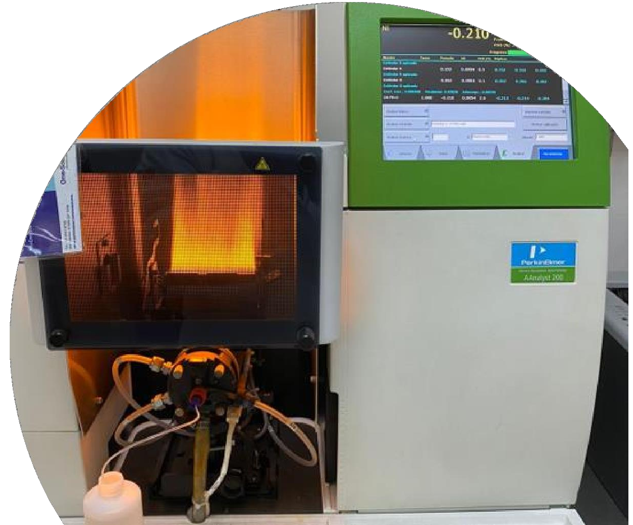
Figura 9: Equipo de Espectrometría de Absorción atómica con llama
